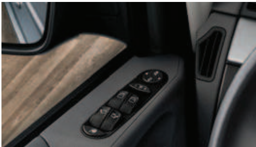
Elektrische Fensterheber, Ausstellfenster und Außenspiegel.
