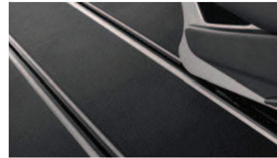
Das Sitzschienensystem für variable Innenraumkonfiguration.
