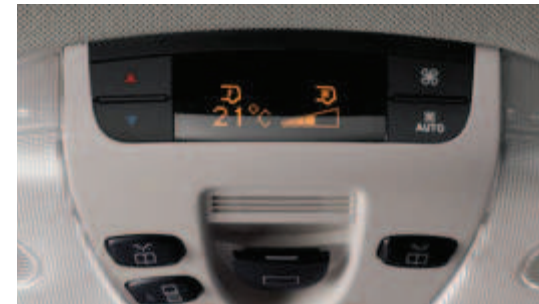
Zusatzwärmetauscher für den Fond mit separater Bedieneinheit.
